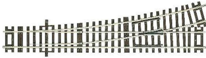
Branchement déviation à gauche
